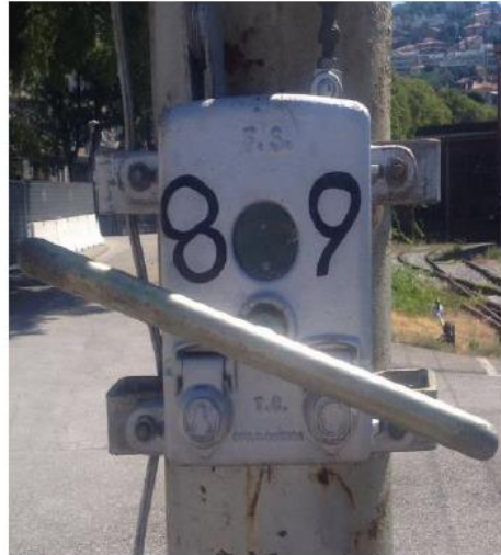
Fig. 5: Argano in posizione di aperto
