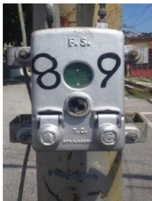
Fig.4:Argano di manovra dei commutatori
